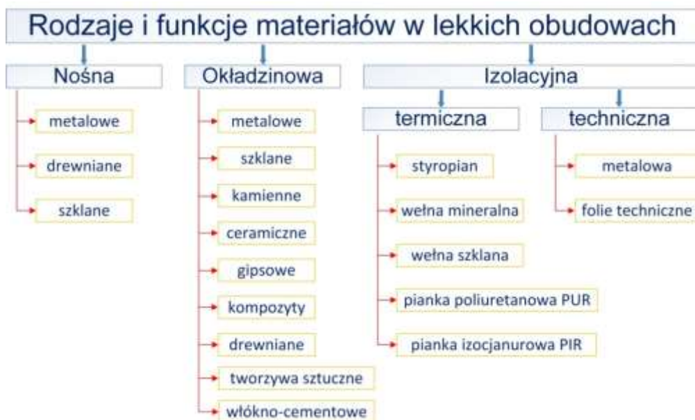
Rys. 4. Rodzaje i funkcje materiałów stosowanych do konstruowania lekkich obudów obiektów budowlanych
