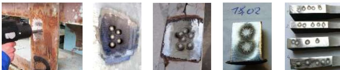
Rys. 3. Przykłady miejsc i stanu powierzchni po wykonaniu badań spektrometrycznych
