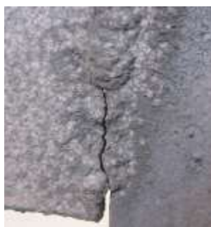
c) pęknięcia na połączeniach spawanych
