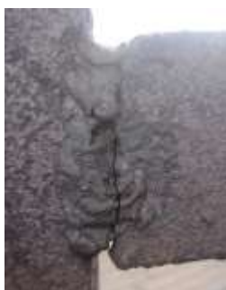
c) pęknięcia na połączeniach spawanych
