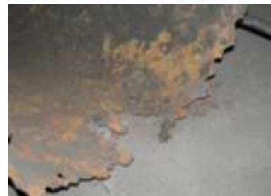
a) stan destrukcji zdemontowanej części trzonu kominowego
