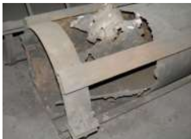
a) stan destrukcji zdemontowanej części trzonu kominowego
