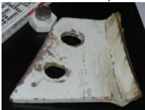
a) zniszczony element wsporczy
