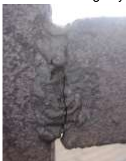
c) pęknięcia na połączeniach spawanych
