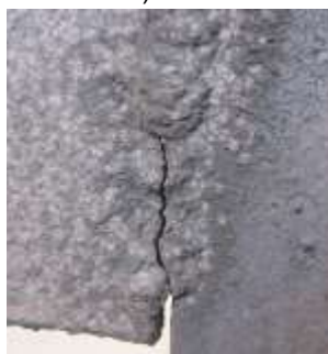
c) pęknięcia na połączeniach spawanych
